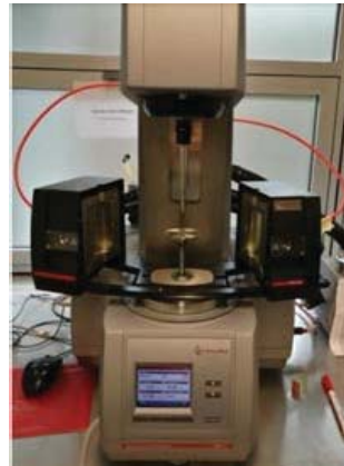
Abb. A 5.1: Versuchsaufbau, Rheometer
