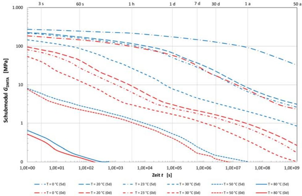
**Abb. A 6.1** Schubmodul  $G(T,t)$  aus DMTA in Abhängigkeit der Temperatur  $T$  und der Lasteinwirkungsdauer  $t$
