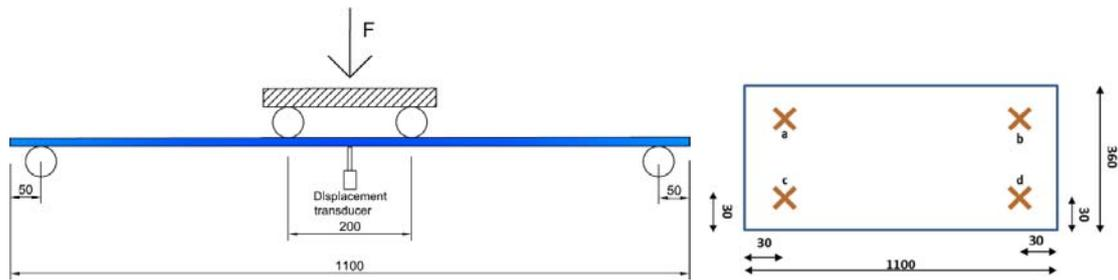
Abb. A 5.2: Biegekriechversuch und Messpunkte
