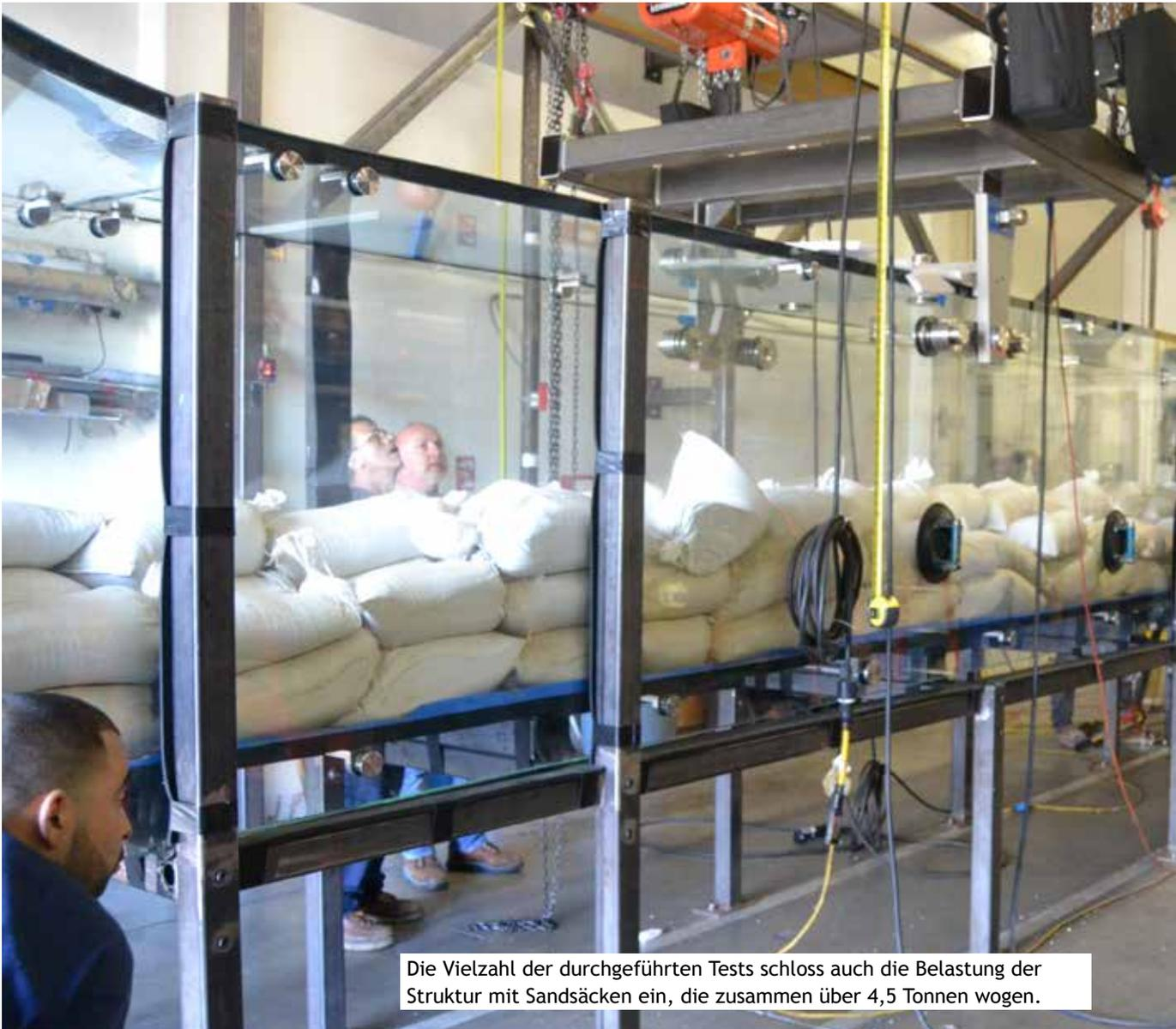
Die Vielzahl der durchgeführten Tests schloss auch die Belastung der Struktur mit Sandsäcken ein, die zusammen über 4,5 Tonnen wogen.
