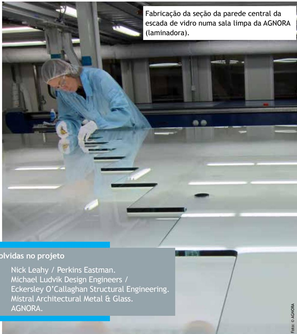
Fabricação da seção da parede central da escada de vidro numa sala limpa da AGNORA (laminadora).
