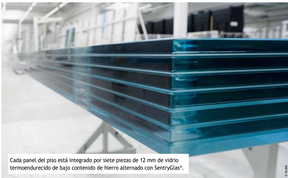
Cada panel del piso está integrado por siete piezas de 12 mm de vidrio termoendurecido de bajo contenido de hierro alternado con SentryGlas®.
