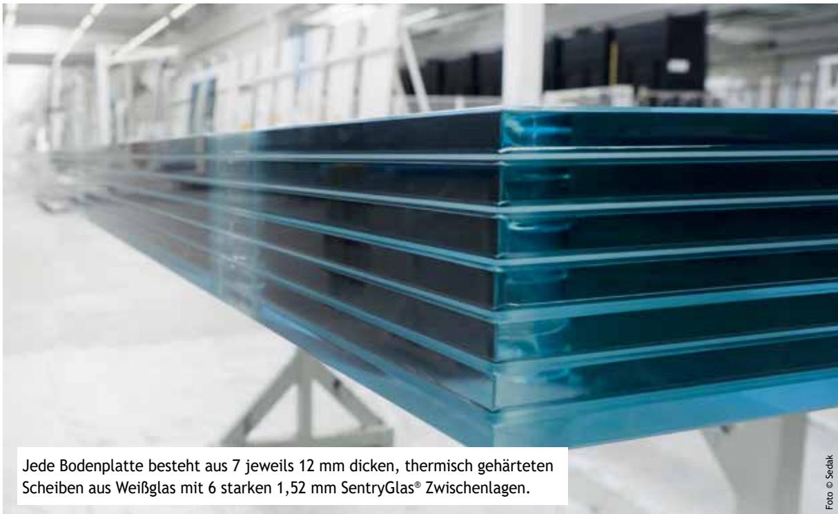
Jede Bodenplatte besteht aus 7 jeweils 12 mm dicken, thermisch gehärteten Scheiben aus Weißglas mit 6 starken 1,52 mm SentryGlas® Zwischenlagen.
