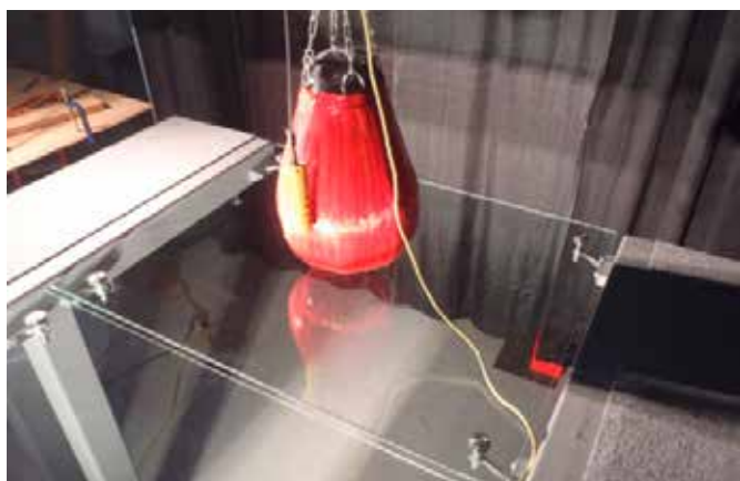
Fig. 2 (a & b): Aplicación de marquesina sin marco (fijada en un punto) sometida a una carga estática
