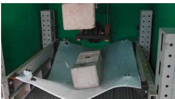
Fig. 12: Laminado con Ionómero de 0,89 colapsó a 200 kg
