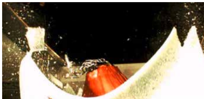
Fig. 6: El laminado con PVB rígido no proporcionaba una resistencia "caída a través"
