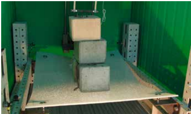
Fig. 8: Carga de 400 kg sobre laminado con Ionómero @ 21\text{ }^{\circ}\text{C}
