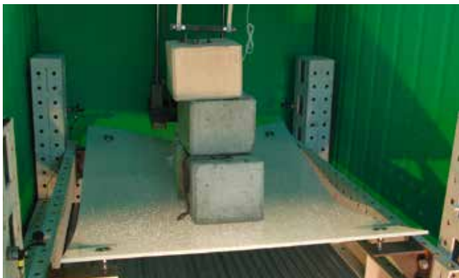
Fig. 8: Carga de 400 Kg sobre laminado Ionomérico a 21 °C
