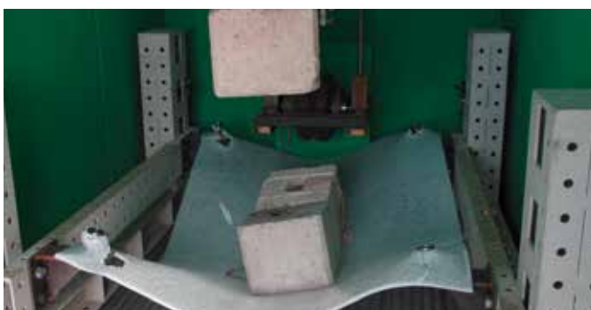
Bild 12: Das Laminat mit 0,89 mm dicker Ionomer-Zwischenlage versagte bei 200 kg/ 50\text{ °C}
