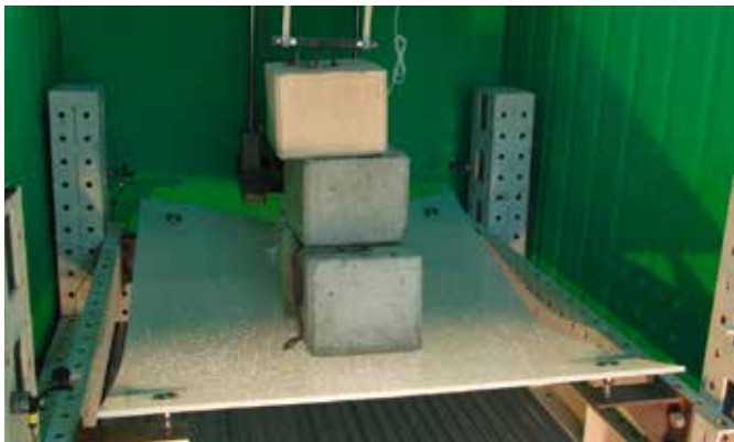
Bild 8: Das Ionomer-Laminat mit 400 kg Belastung bei 21\text{ °C}
