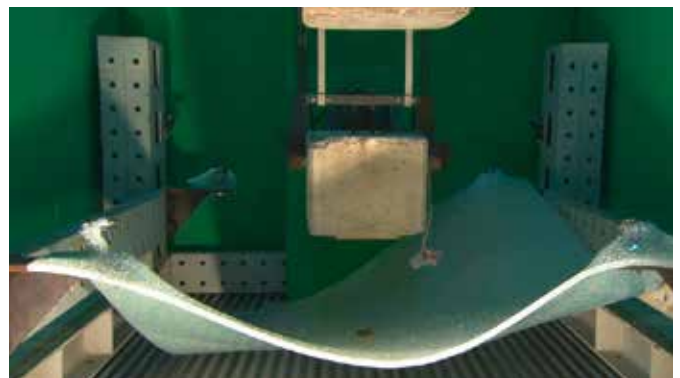
Bild 11: Das zerstörte Laminat mit steifem PVB bei 50\text{ °C}
