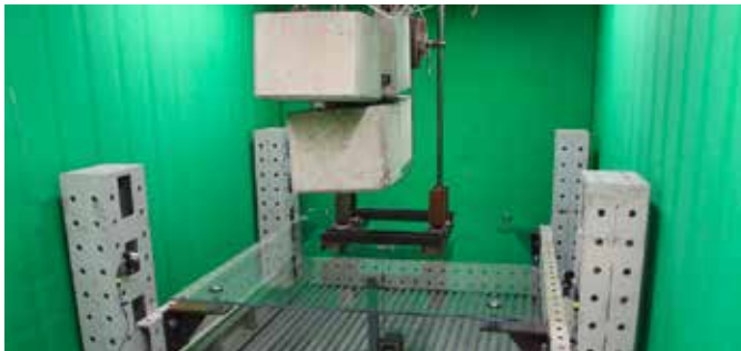
Bild 7: Versuchsaufbau zur Messung der Resttragfähigkeit nach Glasbruch
