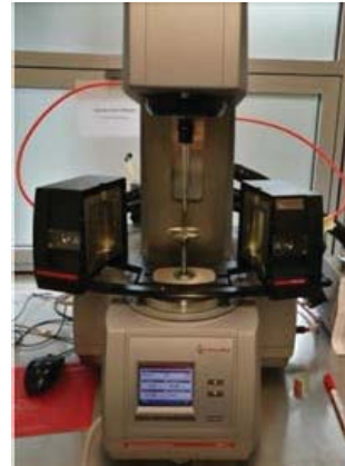
Abb. A 5.1: Versuchsaufbau, Rheometer
