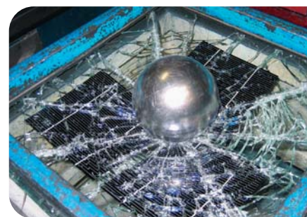
DIN52338によるボールドロップテスト
