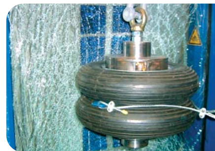
EN12600による振り子破壊テスト
